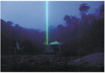
Lidar-Messung im brasilianischen Regenwald bei Nacht. Zu sehen sind die in die Atmosphäre ausgesendeten grünen Laserpulse mit einer Wellenlänge von 532 nm.
