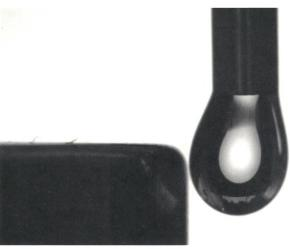
Wirkung eines Handmagneten auf einen Tropfen Tensidlösung
