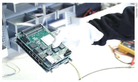
Der Muse-Bordrechner sorgt für eine sichere Positionierung von Raumfahrzeugen.
