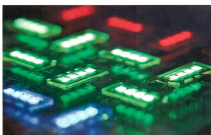
OLED rouges, verts et bleues avec une surface active de 2 x 2 mm pour des tests de performance.
