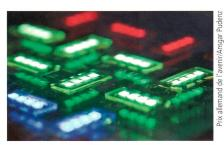
OLED rouges, vertes et bleues avec une surface active de 2 x 2 mm pour des tests de performance.
