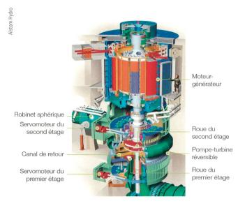
Figure 2 Vue en coupe d'un des groupes réversibles à double étage réglable contrôlé par deux cercles de vannage synchronisés de la centrale de pompage-turbinage de Yang Yang, KHNP, Corée du Sud. Cette centrale est constituée de quatre groupes de 258 MW sous 800 m de chute tournant à 600 min-1.
