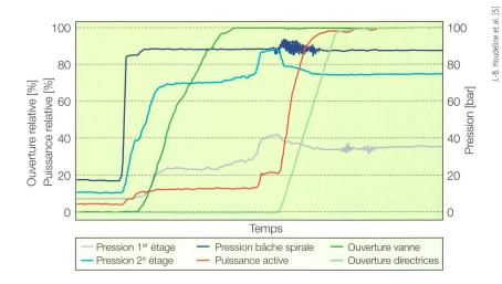
**Figure 4** Evolution de la puissance active et de la pression dans chacun des deux étages, la bâche spirale et la vanne de garde en fonction de l'ouverture des directrices dans le cas d'un démarrage roue dénoyée suivi du remplissage et de l'ouverture des directrices.
