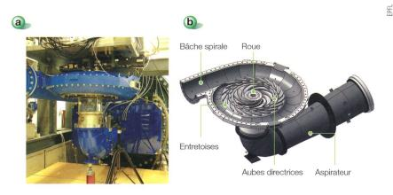
**Figure 5** Modèle d'étude instrumenté du projet Hydrodyna installé sur la plateforme PF2 de l'EPFL (a) et vue éclatée du modèle CAO (b).
