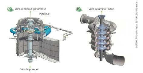
**Figure 1** Equipement de la centrale de pompage-turbinage du projet FMHL. Vues en coupe de la turbine Pelton à 5 injecteurs (a) et de la pompe à 5 étages (b).
