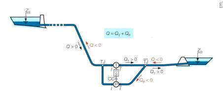
Figure 3 Schéma du principe de fonctionnement en court-circuit hydraulique.
