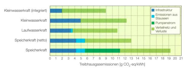
**Bild 3** Treibhausgas-Emissionen der verschiedenen Prozess-Stufen bei der Produktion und Lieferung von Strom mit verschiedenen Wasserkraftwerken. Zum Vergleich: Der Schweizer Strommix verursacht auf Stufe «Niederspannungs-Steckdose» 149 g CO<sub>2</sub>-eq/kWh.
