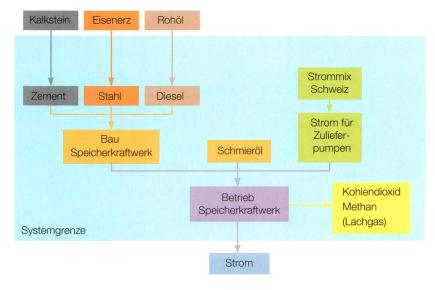
**Bild 2** Flussdiagramm «Strom aus Speicherkraftwerken» (unvollständig). Lachgasemissionen treten im Betrieb von alpinen Speicherkraftwerken nicht auf. Der Strom für Zulieferpumpen wird meist als Betriebsaufwand verbucht und vom Netz bezogen.
