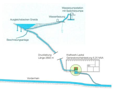
**Bild 1** Wasserkraftwerk Ladral. Oben sieht man die Pumpstation mit Zuführpumpe, die 100 l/s Wasser fördert.
