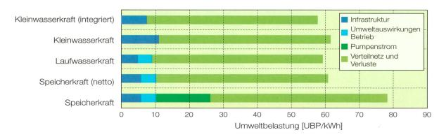
**Bild 4** Gesamtumweltbelastung der verschiedenen Prozess-Stufen bei der Produktion und Lieferung von Strom mit verschiedenen Wasserkraftwerken. Zum Vergleich: Der Schweizer Strommix verursacht auf Stufe «Niederspannungs-Steckdose» eine Gesamtumweltbelastung von rund 460 Umweltbelastungspunkten (UBP).
