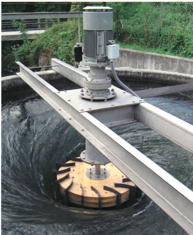
Bild 1 Das kompakte 10-kW-GWVPP mit Asynchrongenerator, Planetengetriebe und Zotlöterer-Turbine in Obergrafendorf, Österreich, produziert jährlich 60 000 kWh.
