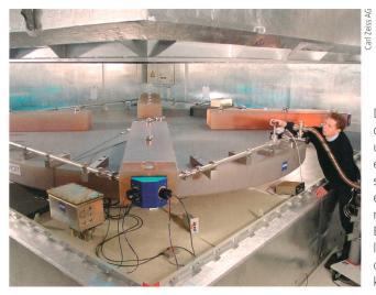
Der Ringlaser des Geodätischen Observatoriums Wettzell. Zwei entgegengesetzte Lichtstrahlen durchlaufen eine guadratische Bahn mit Spiegeln in den Ecken. Aus der Wellenlängendifferenz kann die Drehgeschwindigkeit ermittelt werden.
