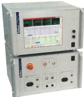
Tettex-Prüfgerät für die Messung von dielektrischen Eigenschaften an Öl- und Feststoffen.
