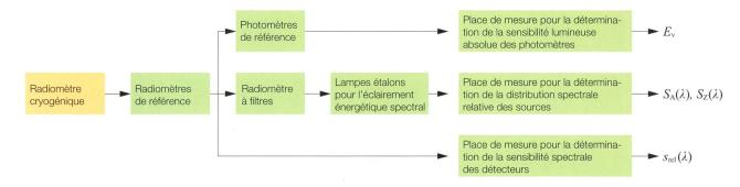
Figure 4 Traçabilité de la mesure d'une source de lumière colorée au METAS: la distribution spectrale relative de la lampe de calibration  $S_7(\lambda)$  et de la source à mesurer  $S_{\Delta}(\lambda)$  ainsi que la réponse spectrale du photomètre  $S_{rol}(\lambda)$  permettent de calculer le facteur de correction  $F_7$  et de corriger l'éclairement lumineux  $E_{v}$ .
