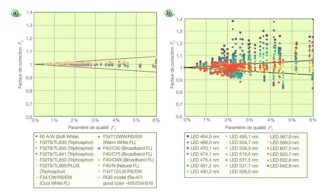
Figure 3 Facteurs de correction  $F_7$  en fonction du paramètre de qualité  $f'_1$  pour différentes sources de lumière : (a) Sources blanches. (b) Sources LED de couleur.
