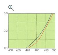
Figure 1 Adaptation spectrale d'un photomètre à la courbe normalisée photopique de l'œil humain. Pour les sources lumineuses à bande étroite, l'imperfection de la concordance peut engendrer d'importantes erreurs.
