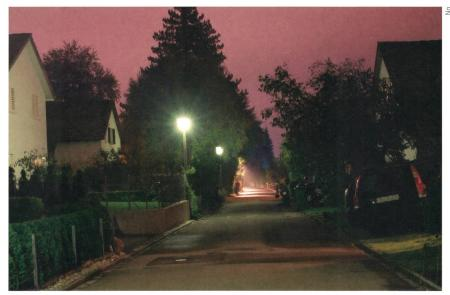
**Bild 3** «Pilzleuchten» (vorne) und LEDs beleuchten die Röslistrasse. Die Huber-Pilzleuchten sind mit HQL-Quecksilber-Leuchtmitteln mit einer Leistung ohne Vorschaltgerät von 50 W und die LEDs mit Mini-Quadrolux-2-Leuchtmitteln mit einer Leistung ohne Ansteuerung von 31 W ausgestattet.
