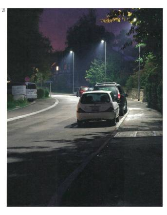
**Bild 2** Wo Licht ist, ist auch Schatten – ein Nebeneffekt der LED ist der ausgeprägte Schattenwurf, wenn Äste im Lichtkonus stehen (Strangenstrasse, Wallisellen).
