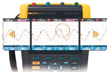
Das für industrielle Umgebungen entwickelte, tragbare Oszilloskop ScopeMeter 190 Serie II.
