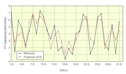
**Bild 4** Der spezifische Ertrag von Fotovoltaikanlagen kann basierend auf Meteodaten innerhalb von 24 h gut prognostiziert werden. Der Elektrizitätsversorger einer Region kann damit die Regelstrategie von lokalen Lastmanagement-Systemen anpassen.
