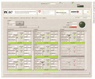
Jedes der angesteuerten Geräte besitzt zusätzlich eine eigene Intelligenz, den «Lastmanager Gerät». So werden beim Ausbleiben von Steuersignalen im Falle eines Kommunikationsunterbruchs die Boiler durch lokale Temperaturregler weiterbetrieben. Auch die maximale Zeit, während der ein Gerät blockiert werden kann, ist durch einen lokalen Timer begrenzt. Mit diesen Vorkehrungen konnte während der gesamten Versuchsdauer ein Ausfall der angesteuerten Geräte vermieden werden.
