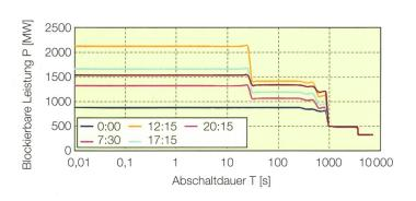
**Bild 1** Lokales Lastmanagement zur Stabilisierung des Stromnetzes. Die Grafik zeigt, dass mit Geräten im Haushalt, in Abhängigkeit der möglichen Abschaltdauer ohne Komfortverlust, zu verschiedenen Tageszeiten bis über 2 GW Leistung blockiert werden kann.
