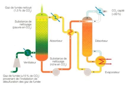
Principe du procédé PCC de Siemens: le CO<sub>2</sub> produit par la combustion est extrait à plus de 90 % des gaz de fumée grâce aux substances de nettoyage spécialement développées.
