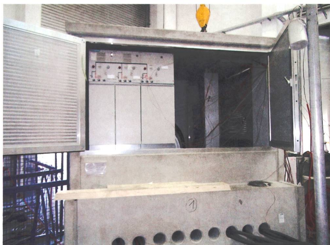
Die Cellpack-Trafostationen haben die sehr gute Bemessungs-Gehäuseklasse 15 erreicht.
