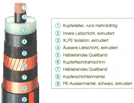
Bild 3 Aufbau des eingesetzten Kupferschichtenmantelkabels.
