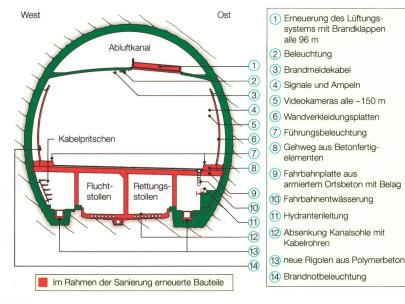
Bild 1 Tunnelquerschnitt nach dem Umbau
