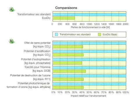
**Figure 4** Comparaisons des pertes à vide (a) et du bilan écologique (b) d'un transformateur sec EcoDry amorphe et d'un transformateur standard.
