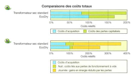
**Figure 3** Comparaison des coûts totaux de transformateurs secs en configuration standard et avec noyau en métal amorphe (EcoDry) pour des applications dans un réseau de distribution (a) et dans une installation photovoltaïque (b).
