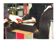
**Figure 1** Transformateur à noyau en métal amorphe lors du montage : l'épaisseur des bandes métalliques amorphes est limitée à environ 25 µm.
