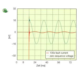
Bild 3 Fall 1: Fester 1-phasiger Fehler, hochohmige Widerstandserdung des Sternpunkts.
