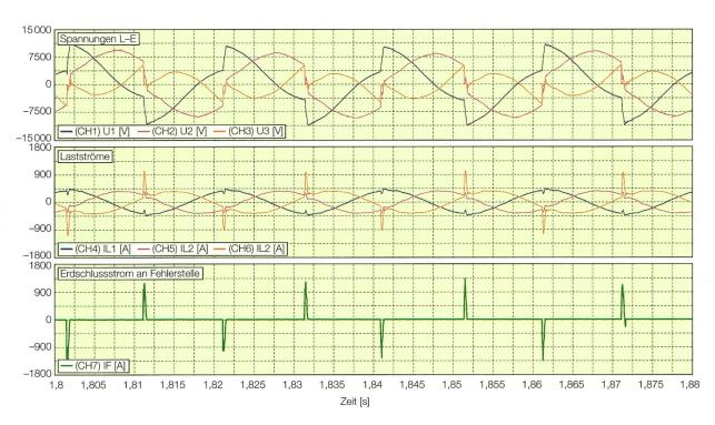
Bild 1 Tests an 8-kV-Kabel [5, 6]; Situation nach einem einphasigen Lichtbogenfehler.
