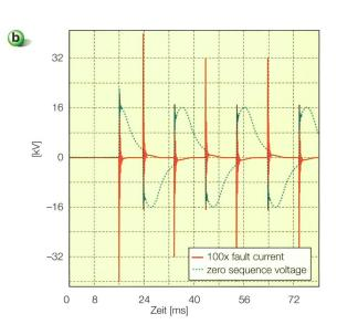
Bild 4 Fall 2: Intermittierender 1-phasiger Fehler, hochohmige Widerstandserdung des Sternpunkts.
