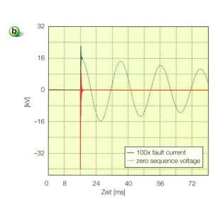
Bild 5 Fall 5: Intermittierender 1-phasiger Fehler, Erdung des Sternpunkts über Petersen-Spule.
