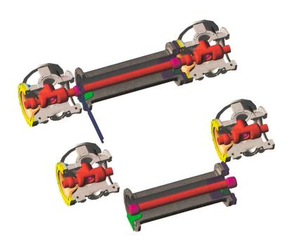
**Bild 3** Prinzipbild einer mechanischen Trennstelle.
