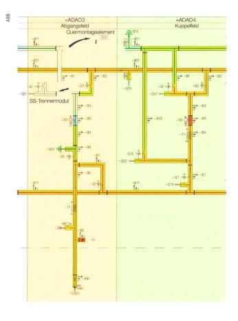
Bild 2 Durch das Entfernen des Querdemontageelementes in der SS1 kann der fehlerhafte Abgang via Kuppelfeld und Umgehungsschiene wieder in Betrieb gehen.
