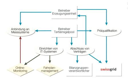
**Bild 3** Schritte zum Aufbau eines Tertiärregelpools.
