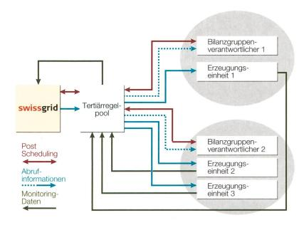
**Bild 1** Abwicklung eines Abrufs aus einem Tertiärregelpool.
