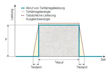
**Bild 2** Pauschale Bestimmung der Ausgleichsenergie.
