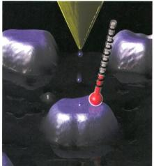
Principe du réchauffement d'un nanoaimant par un courant tunnel : des électrons (en bleu) sont émis par la pointe d'un microscope à effet tunnel (en jaune) avant d'atteindre le nanoaimant. La fréquence de la commutation magnétique permet alors de déterminer la température, symbolisée ici par un thermomètre. Lorsque le courant est faible, le nanoaimant présente la température de son environnement (à droite). Dès que le courant est augmenté, les électrons réchauffent le nanoaimant (à gauche).
