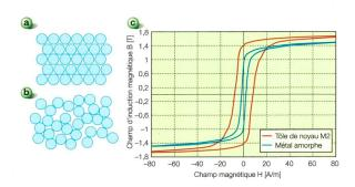
Des transformateurs encore plus efficaces grâce aux noyaux amorphes Quoique très efficaces, les transformateurs sont à la base de pertes énergétiques non négligeables. Une nouvelle gamme de transformateurs munis de noyaux en métal amorphe permet de les réduire considérablement et d'améliorer ainsi
