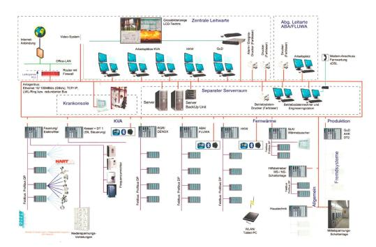
**Bild 4** Hardware-Architektur des Prozessleitsystems.
