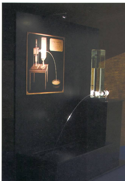
Une réplique moderne de la fontaine de J.-D. Colladon, qui a permis de démontrer pour la 1 ère fois qu'un jet d'eau pouvait guider la lumière.
