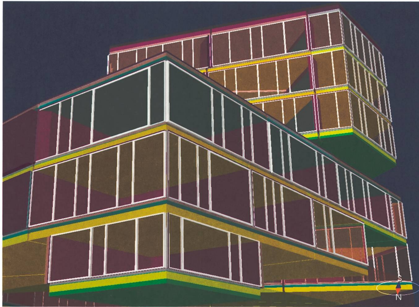
Figure 4 Visualisation graphique de la modélisation du comportement thermique du bâtiment avec le logiciel IDA ICE. Dans cette représentation 3D, la coloration correspond à une température (bleu = froid, rouge = chaud). Lors d'une simulation sur une période donnée, les couleurs évoluent avec la variation des températures et permettent de se rendre compte aisément si le niveau de confort fixé peut être garanti.
