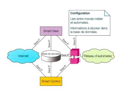
**Figure 5** Schéma de principe du système prédictif et autodidacte de gestion énergétique de Smart Building.
