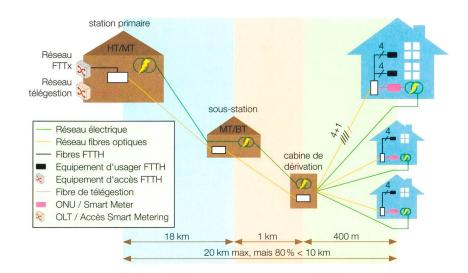
Figure 1 Réseau de distribution et de fibres optiques.
