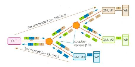
Figure 2 Réseau optique passif.
