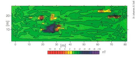
**Bild 6** Resultierende magnetische Feldstärke, die bei UAV-basierten Messungen erzielt werden konnte. Die detektierten Objekte sind deutlich zu erkennen.
