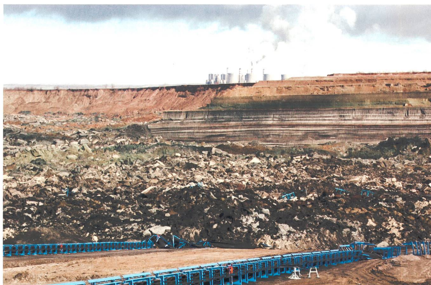
Bild 1 Das Unglücksgebiet in der Osttürkei, bei dem eine Tagebau-Braunkohlemine kollabiert ist. Die ursprüngliche Tiefe der Grube für den Kohleabbau wurde um fast 100 m aufgefüllt.
