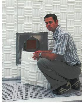
**Bild 4** Eine mit schalldämmendem Material abgeschlossene Durchführung vom Experimentier- zum Hilfsbetriebsraum. Die schwingungsentkoppelte Benutzerplattform, auf der Dr. Lörtscher steht, ist an den Wänden aufgehängt.
