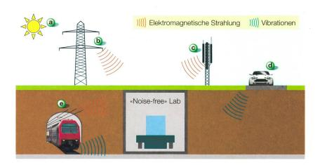
**Bild 2** Einige der Störgrössen, die von aussen auf das Nanotechnologie-Labor in Rüschlikon einwirken. a) Sonne und Jahreszeiten verursachen Temperatur- und Luftfeuchtigkeitsänderungen. b) Elektromagnetisches Störfeld von Übertragungsleitungen (50 Hz). c) Hochfrequente Störfelder von Mobilfunksendern (1,8 GHz). d) Bodenvibrationen von Fahrzeugen auf der Autobahn (150 m entfernt). e) Störfelder (16,7 Hz) u. Bodenvibrationen vom 175 m entfernten Bahntunnel.
