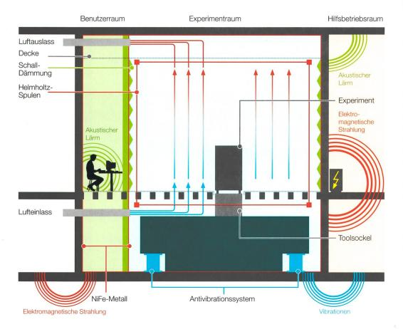
Bild 3 Benutzer- und Hilfsbetriebsraum sind räumlich vom Experimentraum getrennt. Der klimatisierte laminare Luftstrom umfliesst das Experiment, ohne störende Wirbel (Vibrationen) zu verursachen. Der Luftstrom wird durch eine Luftabsaugung in der Decke erzeugt. Alle Wände, Böden und Decken sowie die Trennwand zum Benutzerraum sind mit μ-Metall abgeschirmt. Das Helmholtz-Spulenpaar zur Kompensation niederfrequenter Magnetfelder ist an den Wänden befestigt.
