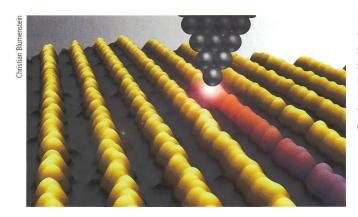
In Nanodrähten aus Goldatomen können sich Elektronen nur in sehr engen Bahnen bewegen. Rechts oben ist die Spitze eines Rastertunnelmikroskops dargestellt.
