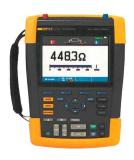
Fluke 190-062 Scopemeter mit 2 Kanälen, bis 60 MHz.
