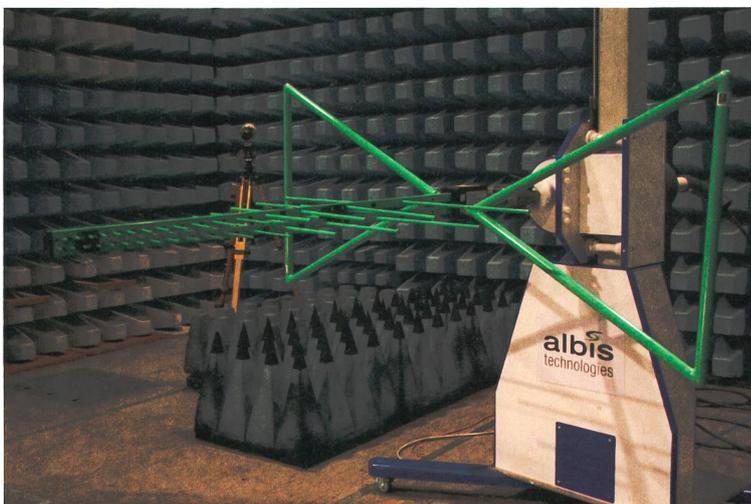
Die absorbierende Halle ermöglicht die EMV-Prüfung von Kommunikationsgeräten und kann z.B. zur Störaustrahlungsmessung bei Netzgeräten verwendet werden.
