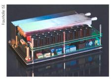
Ladegerät mit einer Leistung von 22 kW.
