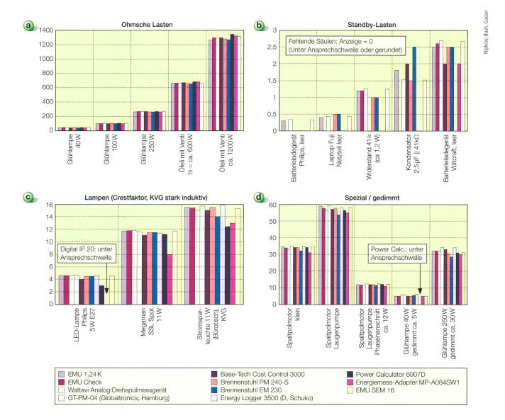
Bild 1 Auswertung der Leistungsanzeigen nach Lasten-Kategorien.
