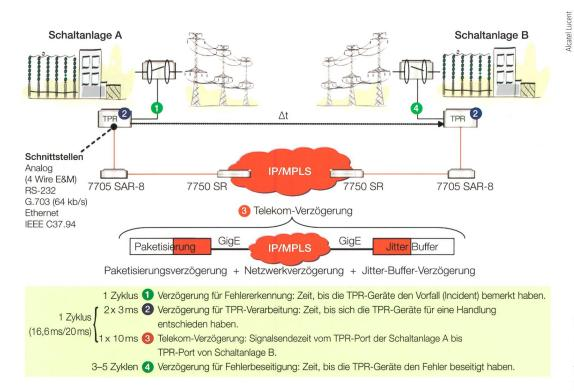
**Bild** Teleprotection über IP/MPLS bei Alta-Link: Verzögerungszeiten zwischen zwei Schaltanlagen.
