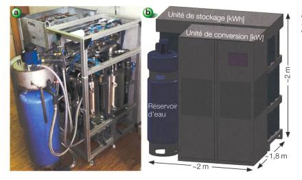
**Figure 4** a) Prototype industriel du système HyPES-2 en cours de mise en service à l'EPFL. b) Illustration 3D d'un système HyPES-2 commercial pour applications résidentielles. Les dimensions indiquées correspondent à un système de l'ordre de 30 kW/60 kWh à 200 bar.
