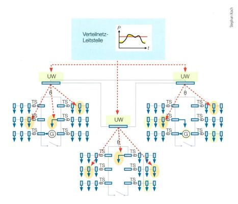
**Bild 2** Schutz der Verteilnetzinfrastruktur. Die gelben Elemente werden durch das Unterwerk, die grünen durch externe Aggregatoren gesteuert.
