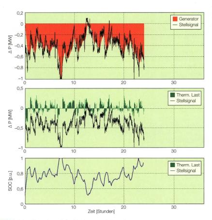
Bild 4 Sekundärregelung mit flexiblen Lasten und einem Generator.
