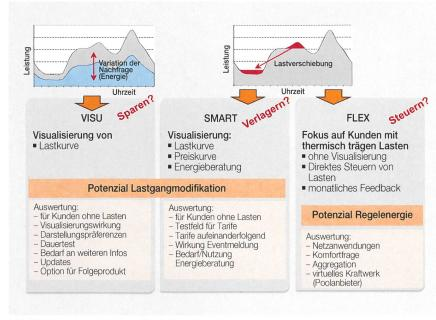
Bild 1 Die Stromprodukte im Überblick.
