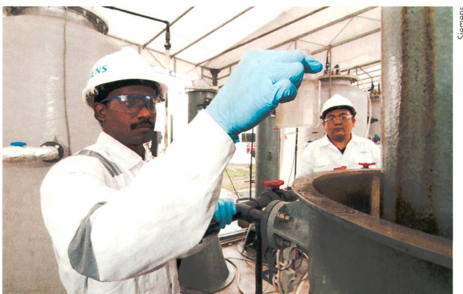
Die Pilotanlage, die energieneutral etwa 0,5 m³ Abwasser am Tag reinigt, steht auf dem Gelände der Wasserwerke Singapurs.
