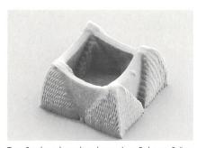
Test-Struktur, bestehend aus einer Polymer-Stützstruktur und einer Protein-Funktionsstruktur.
