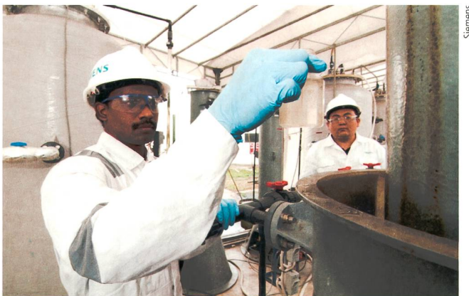
Die Pilotanlage, die energieneutral etwa 0,5 m 3 Abwasser am Tag reinigt, steht auf dem Gelände der Wasserwerke Singapurs.
