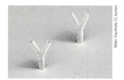
Kapillare aus künstlichem, elastischem Polymer mit einem Durchmesser von 20 µm.
