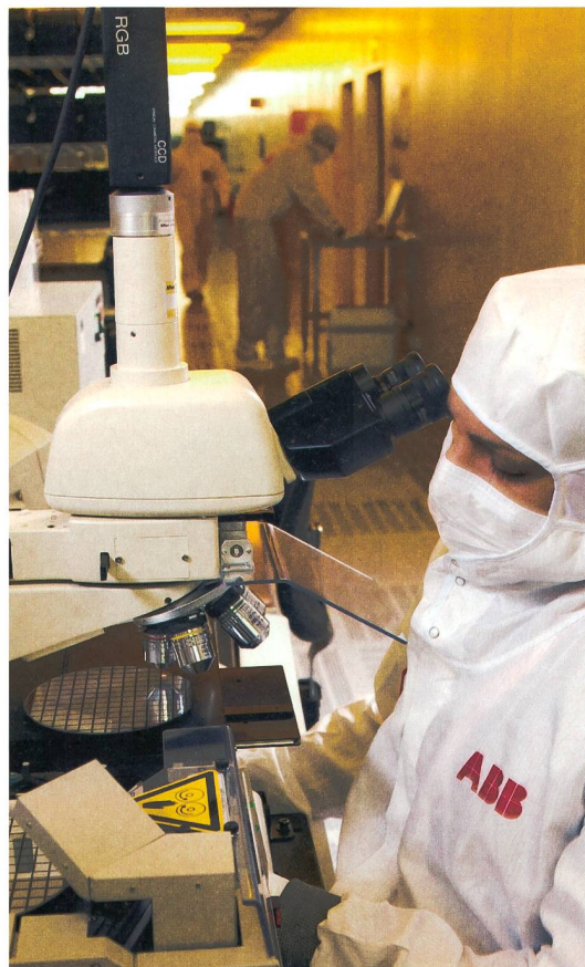
Contrôle d'une plaquette de Si entre deux étapes de fabrication d'IGBT.
