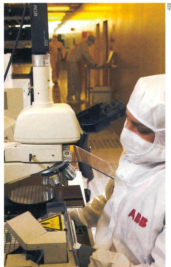
Contrôle d'une plaquette de Si entre deux étapes de fabrication d'IGBT.
