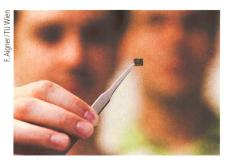
Ein Chip, der Graphen-Flakes enthält.
