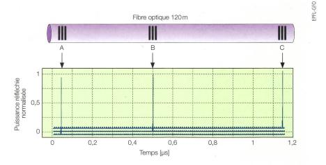
**Figure 4** Ligne de retard basée sur un réflécteur optique généré dynamiquement par l'interaction de deux ondes lumineuses. En positionnant ce réflécteur en différents points (A, B, C) le long de la fibre, la lumière réfléchie peut être retardée continûment sur une large plage temporelle. Le graphe montre une impulsion de 600 ps réfléchie sur ce réflécteur pour trois positions distinctes, démontrant des retards dépassant la microseconde sans distorsion notable.
