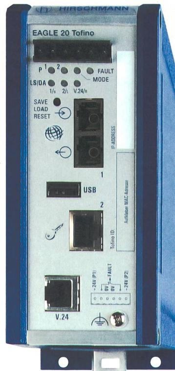
Eagle20 Tofino MM/TX ist eine Komponente eines Systems, mit dem Sicherheitszonen in industriellen Steuerungsnetzwerken realisiert werden können. Alle Systemkomponenten werden zentral mit der Tofino Central Management Plattform, einer Arbeitsplatzrechner-Software, konfiguriert, verwaltet und überwacht.
