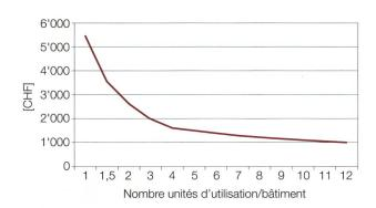
**Figure 2** Coûts des raccordements.
