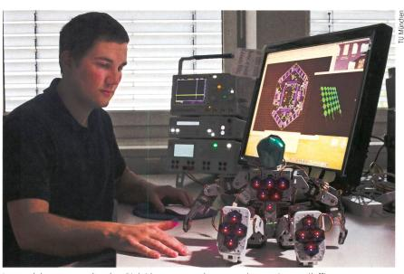
Les modules capteurs du robot Bioloid permettent de mesurer la température, l'effleurement et l'accélération, similaire à la peau humaine.
