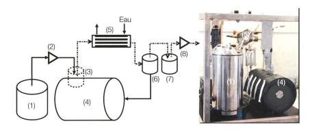
Figure 3 Réacteur (5L) et schéma de fonctionnement.
