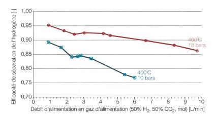
**Figure 5** Efficacité de la séparation H<sub>2</sub>/CO<sub>2</sub>. Pour différents flux de gaz, avec la membrane Pd/Ag, sous différentes condition de pression.
