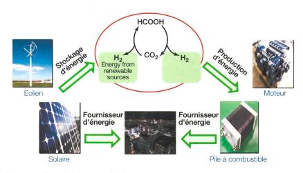
Figure 1 Cycle Acide formique-Hydrogène
