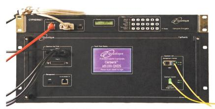
**Figure 2** Système commercial de chiffrement avec distribution quantique de clé. Equipement inférieur: serveur quantique de clé. Equipement supérieur: boîtier de chiffrement Gigabit Ethernet.
