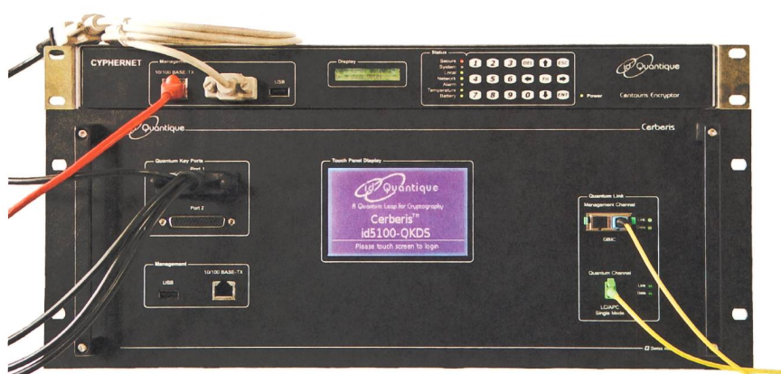
Figure 2 Système commercial de chiffrement avec distribution quantique de clé. Equipement inférieur : serveur quantique de clé. Equipement supérieur : boîtier de chiffrement Gigabit Ethernet.
