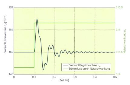
Bild 6 Zeitverlauf der Drehzahl mit Integralanteil in der Regelung bei Netzfrequenzänderung.
