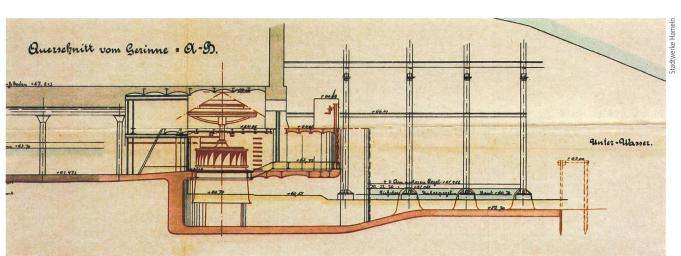
Bild 1 Wasserkraftwerk Weser in Hameln, Schnitt durch das alte Kraftwerk Ostgerinne, maximale Fallhöhe 2,80 m, Wasserdurchfluss ca. 12 m³/s, Leistung ca. 300 kW.
