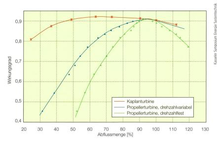
**Bild 2** Vergleich der Wirkungsgrade von Propeller- und Kaplanturbine bei voller Laufradöffnung der Propellerturbine [2].
