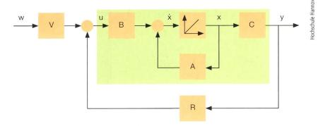
**Bild 5** Zustandsraumdarstellung des Doppelantriebs mit Ausgangsrückführung und Sollwertvorgabe. w: Eingangsvektor, u: Eingangsvektor, x: Zustandsvektor, y: Ausgangsvektor, A: Systemmatrix, R: Rückführmatrix.
