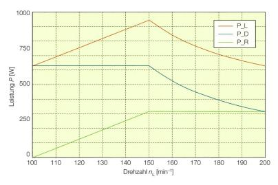
**Bild 4** Leistungen der Turbine und der Antriebe R und D bei konstantem Drehmoment im unteren und bei konstanter Leistung im oberen Drehzahlbereich.
