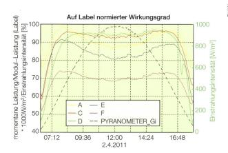
**Bild 2** Tageszeitlicher Verlauf des relativen Wirkungsgrades der unterschiedlichen Solarmodultechnologien bezogen auf den Typenwert der Nennleistung nach Herstellerangaben und der Einstrahlungsmessung am 2. April 2011, EKZ-Referenzdach Dietikon.
