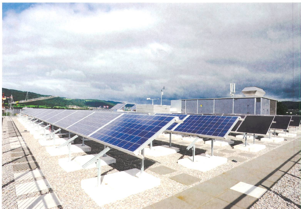
Bild 1 Fünf verschiedene Solarmodultechnologien werden in Dietikon getestet: polykristallines Silizium, Silizium-HIT, Dünnschicht uc-Si/a-Si, Dünnschicht-CIS und Dünnschicht-CdTe.
