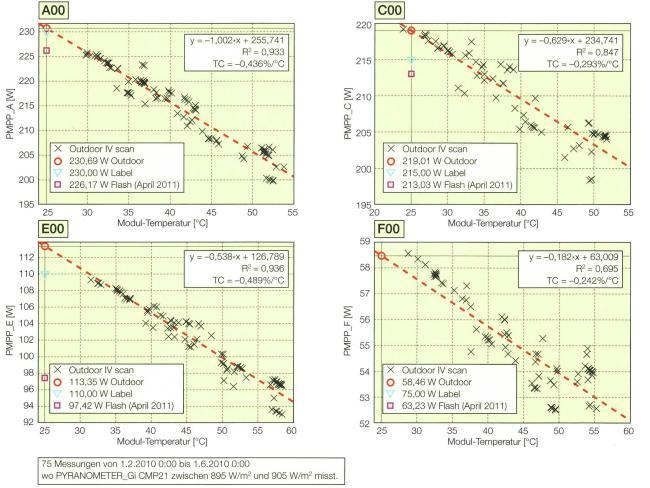
**Bild 3** Bestimmung des Temperaturkoeffizienten (TC) der Nennleistung (Tabelle 1) und der STC-Modulnennleistung durch Sortierung der Outdoor-Messdaten im Einstrahlungsintervall von 895 bis 905 W/m² (Leistungsachse linear auf STC skaliert).
