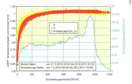
**Bild 5** Schwachlichtverhalten der Spannung im MPP auf 25 °C bezogen und die Flashermessung im April 2011 am Beispiel von Typ A und Typ C. Dabei wurde der Temperaturkoeffizient linear mit der Einstrahlungsleistung berechnet. Zusätzlich wurde die Häufigkeitsverteilung der gemessenen Jahreseinstrahlungssumme in der geneigten Ebene dargestellt.
