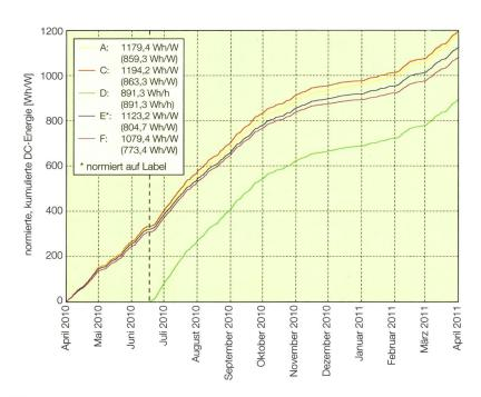
**Bild 6** Vergleich der DC-Jahreserträge der Technologien bezogen auf die im April 2011 durchgeführten Flashermessungen, mit Ausnahme der Technologie Typ E. Technologie Typ D wurde erst im Juni 2010 installiert. (Diese Jahresenergiewerte der einzelnen Referenzmodule unterscheiden sich vom jeweiligen Stringertrag um weniger als 2 %).
