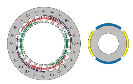
Figure 2 Bobinage réparti (24 dents et 2 paires de pôles).
