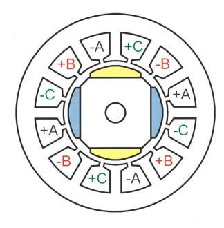
**Figure 1** Moteur synchrone à aimants permanents (Brushless).
