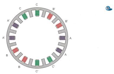
Figure 3 Bobinages concentriques (24 dents et 11 paires de pôles) (a) bobine sur chaque dent (« all teeth »)
