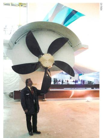
Figure 4 Une des hélices de PlanetSolar. Ces hélices, d'un diamètre de 2 m, ont des pales orientables et leur fonctionnement semi-immergé leur assure un rendement très élevé, allant jusqu'à 80 % selon les conditions d'utilisation.
