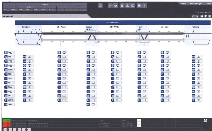
Bild 2 Übersichtsbild der Tunnelleittechnik.
