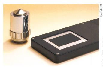
Das dünne Mikroskop (rechts) bildet in einem Durchgang Objekte in der Grösse einer Streichholzschachtel ab. Links ein Standard-Mikroskopobjektiv.
